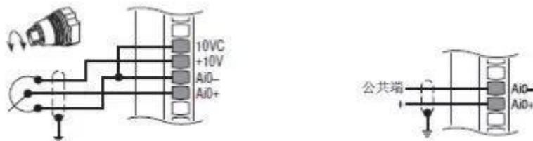
推荐 10k 欧电位计(2k 欧最小), 电位计接法 外部电压信号或者电流信号输入调速接线方法.
