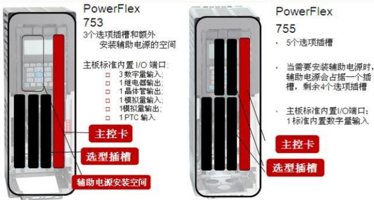
插槽可供通讯卡, 安全卡, 编码器反馈卡, 扩展 I/O 卡和辅助电源使用
